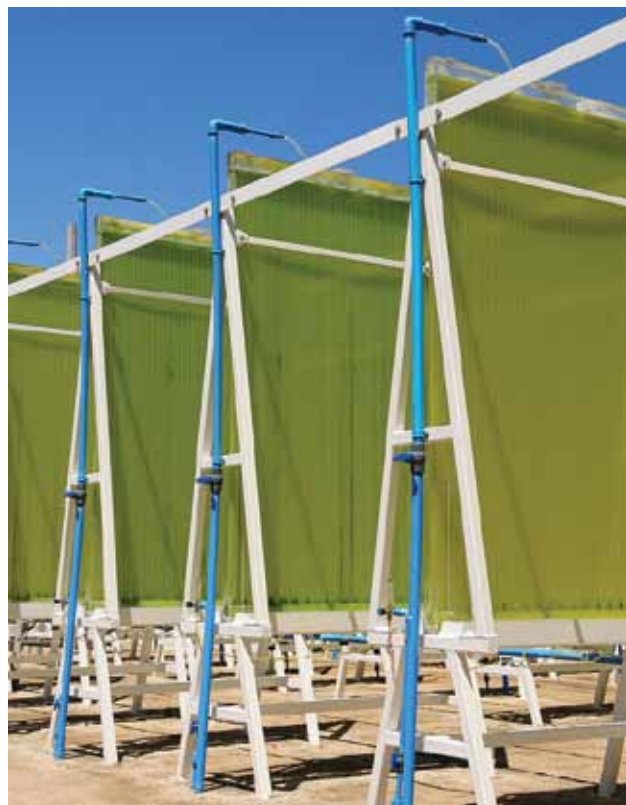
Figura 2 – Instalação piloto para a produção de microalgas em fotobiorreactores alveolares planos a partir de gases emitidos por central térmica em Ventanas, Chile.
