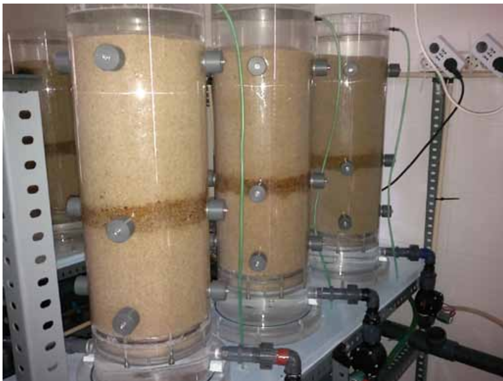
Figura 2 – Sistema de mesocosmos para simulação de processos de biorremediação de petróleo enterrado em colunas de areia sujeitas a ciclos de marés de 12/12 horas.
